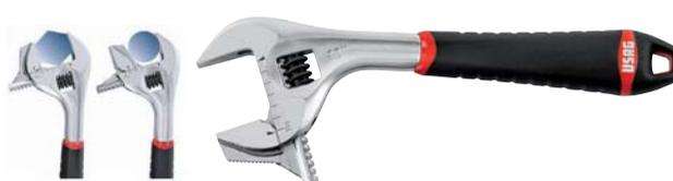
Chiave regolabile reversibile a rullino ASME B107.100 con testa inclinata di 22°, con doppia scala: millimetrata e in pollici, apertura rapida della ganaschia mobile con arretramento del rullino o mediante la sua rotazione, corpo in acciaio al cromo vanadio, esecuzione cromata con testa lucida, impugnatura ergonomica bimatériauale. Inversione della ganaschia mobile per operare anche su profili tondi.
