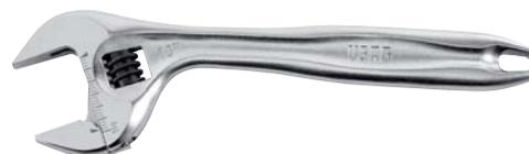
Chiave regolabile a rullino ASME B107.100 con testa inclinata di 22°, con doppia scala: millimetrata e in pollici, apertura rapida della ganaschia mobile con arretramento del rullino o mediante la sua rotazione, corpo in acciaio al cromo vanadio, esecuzione cromata con testa lucida.
